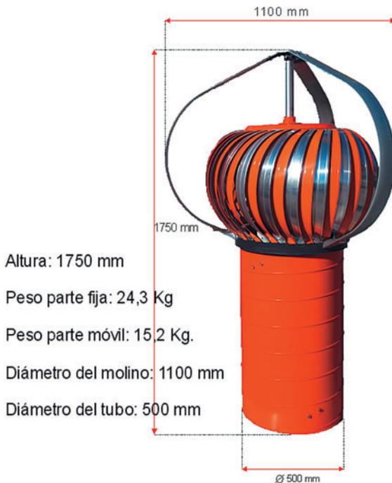
**Figura 1.** Medidas y pesos del molino extractor eólico.
