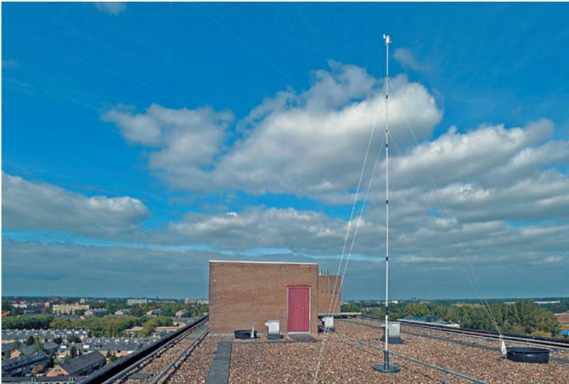
**Figura 2.** Torre anemométrica instalada en techo de edificio.
