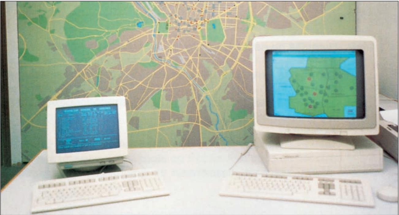
Fig. 8.7.- Unidad de control remoto del sistema de gestión centralizada de las instalaciones de alumbrado público
