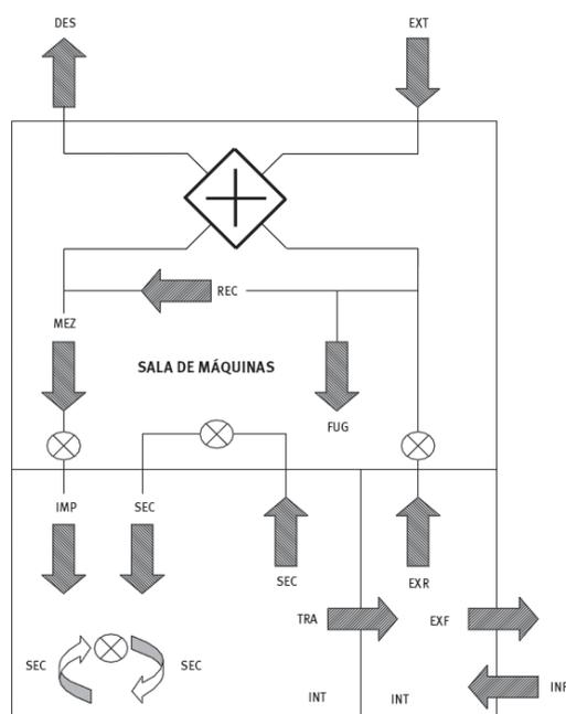
**Figura 1.** Incorporación del recuperador de calor.
