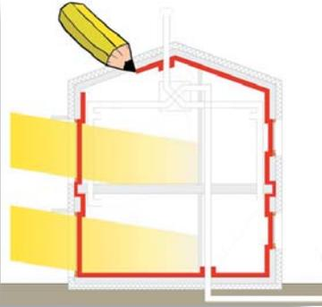
Uno de los dispositivos que llaman la atención en *Passivhaus*, es la resistencia eléctrica (RES) en línea del flujo de admisión. Este elemento de baja eficiencia energética parece estar fuera de contexto en edificios de consumo de energía casi nulo.
