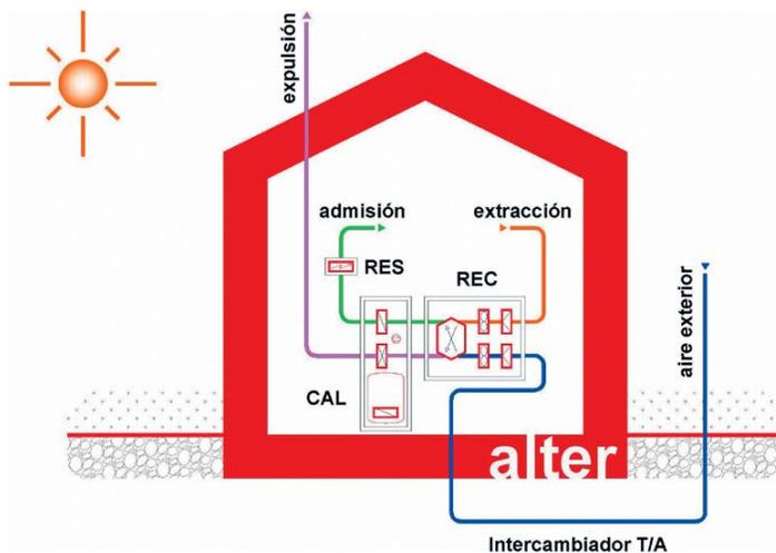
Figura 5. VMC con recuperación, resistencia y calentador termodinámico. Fuente: Alter Technica.
