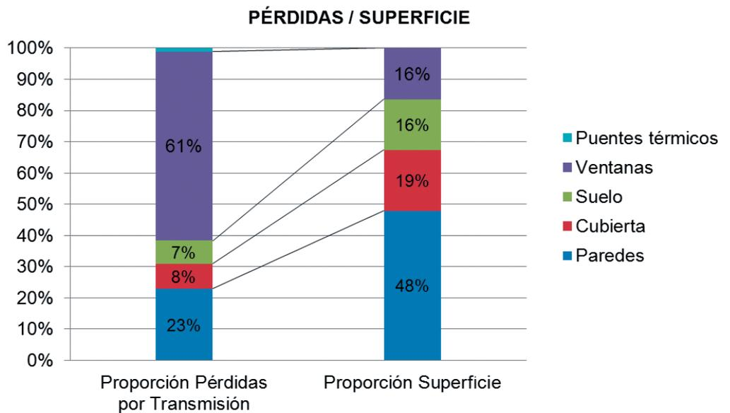
**Gráfico 1.** Pérdidas de calor de los diferentes componentes de la envolvente térmica de un edificio en relación a la superficie que ocupan elaborado a partir de los datos obtenidos por el PHPP. Basado en un proyecto de vivienda unifamiliar real.
