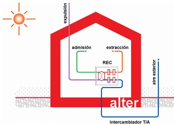
Figura 3. VMC con recuperación e intercambiador tierra/aire.
