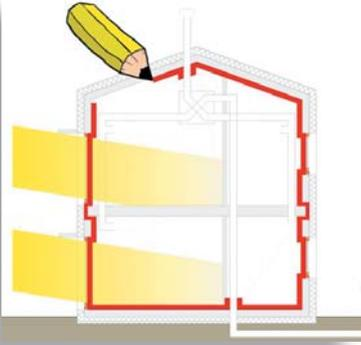
atempera mediante intercambio térmico con el terreno, de temperatura más estable que el propio aire exterior, antes de la entrada en el equipo recuperador de energía.
