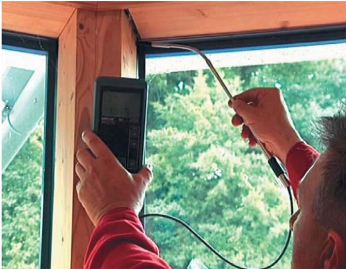
Fotografía 5. Control de infiltraciones en las ventanas.
