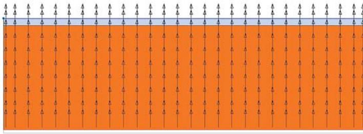
**Figura 1.** Líneas de flujo de calor en una pared constituida por un bloque de arcilla de 29 cm y aislamiento exterior. Los bordes derecho e izquierdo se consideran adiabáticos en su estudio, por considerar que estamos alejados del borde.
