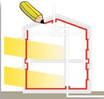
En el estándar *Passivhaus* no importa sólo el espesor del aislamiento en fachadas, cubiertas y suelos sino una continuidad del mismo entre todos estos elementos.
