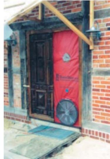
**Fotografías 3 y 4.** (izq.) Test BlowerDoor en vivienda unifamiliar de nueva construcción. (dcha.) Test BlowerDoor en rehabilitación de edificio con estructura de madera.
