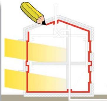
permeable. En cambio una lámina de PE es hermético pero no permeable a la difusión de vapor. Enlucidos interiores (como yeso, estuco, yeso o cemento reforzado con fibras) son generalmente bastante herméticos, pero permeables. Del mismo modo se comportan por ejemplo los tableros de fibras de madera orientada (OSB).
