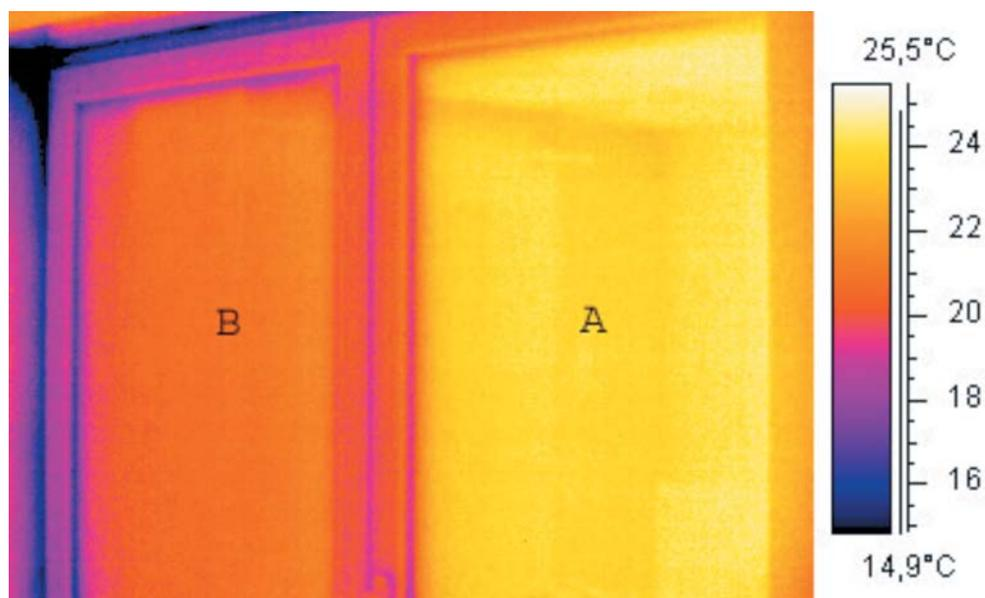
**Fotografía 3.** Termografía de la superficie de dos láminas de ventana: la lámina (B) muestra menos temperatura, por tanto presenta menos pérdidas de calor que la (A) debido probablemente a: problemas en el recubrimiento de baja emisividad, rotura de una de las dos láminas dobles, fuga del gas argón de relleno.
