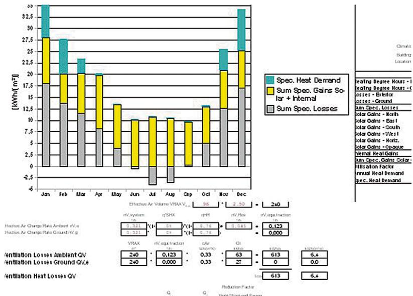
**Figura 1.** Captura de pantalla del PHPP de la demanda de energía primaria total con ejemplo introducido.
