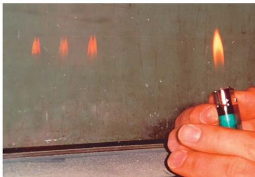
**Fotografía 3.** Imagen de comprobaciones en obra de la posición de las láminas en los vidrios
