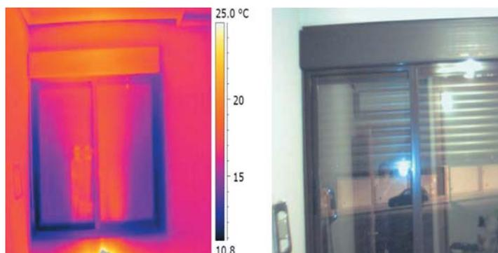
**Fotografía 2.** Termografía infrarroja de una ventana de aluminio de carpintería de muy mala calidad mostrando una temperatura superficial interior muy baja.
