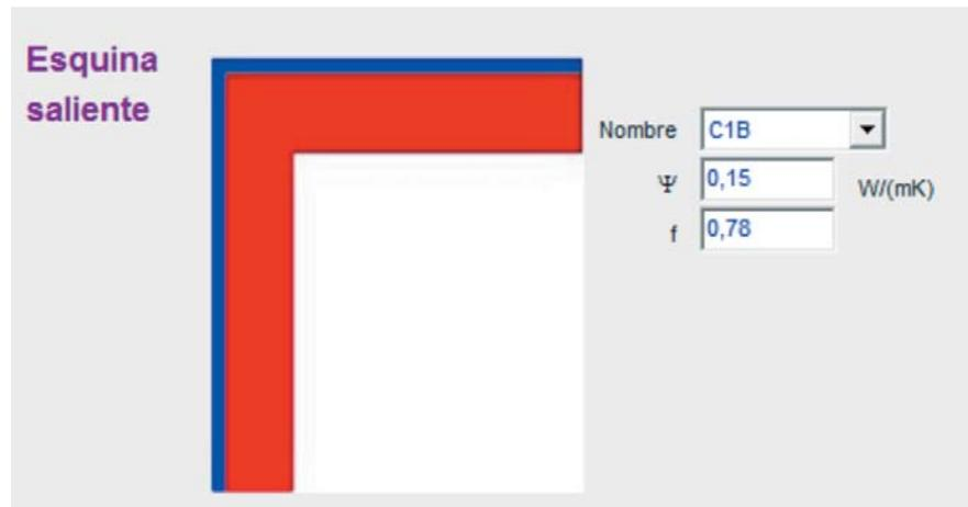
**Figura 6.** Diálogo de configuración de LIDER (Clima B) para un PT de esquina saliente. Valores por defecto para un aislamiento exterior (en azul) y fábrica de ladrillo interior (en rojo) sin detalles de espesores.
