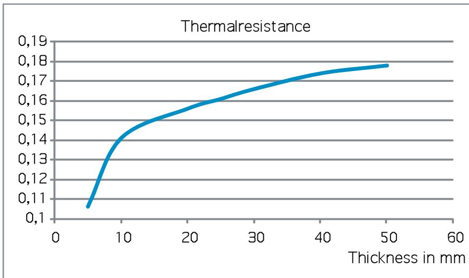
**Gráfico 1.** Resistencia térmica en función del espesor.
