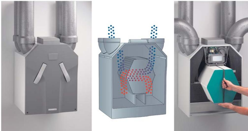
**Fotografía 1.** Recuperador de calor: el intercambiador aire/aire, ventiladores de admisión y expulsión de alto rendimiento, filtros y sistema de control, se integran en un mismo mueble muy bien aislado y de alta hermeticidad.
