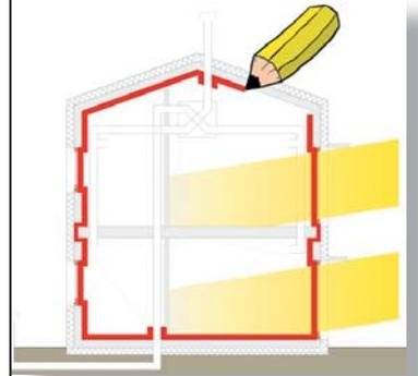
**Figura 7.** Ubicación de los puentes térmicos en la junta vidrio-marco e instalación en ventanas.  $l_{glazing}$  y el  $l_{frame}$  que es necesario estimar e introducir en el PHPP para el cálculo de las pérdidas energéticas correspondientes.
