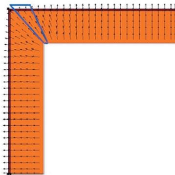
**Figura 2.** Líneas de flujo de calor en una esquina saliente con la misma solución constructiva que en el caso de la fotografía 1. Puede apreciarse cómo el flujo sufre una desviación respecto de la dirección perpendicular al cerramiento cuando nos acercamos a la esquina.
