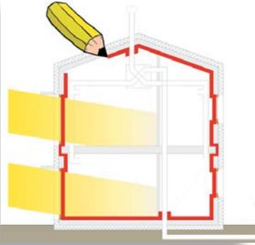
En zonas con elevado nivel de radiación solar es más aconsejable apostar por las ganancias solares pasivas a través de los huecos que a través de los paramentos opacos, por ser las primeras más fácilmente controlables en verano. Evitar las ganancias solares en fachadas y cubiertas se consigue con dos estrategias básicas: uso de colores claros que aumenten la reflexión del sol y uso de dobles pieles ventiladas en las cuales la piel exterior juega el papel de protección solar.
