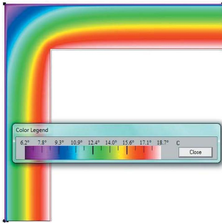
**Figura 5.** Valor de las temperaturas en los cerramientos para una temperatura exterior estable de 6,2 °C y 20 °C en el interior. La temperatura superficial interior de la esquina es de 17,1 °C.
