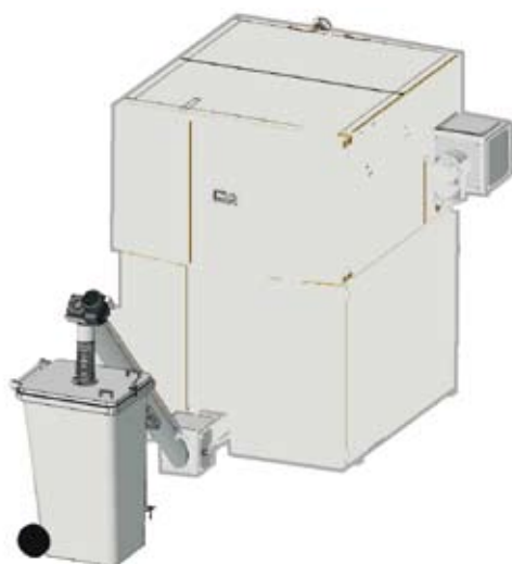
Figura 68: Sistema de extracción de cenizas
