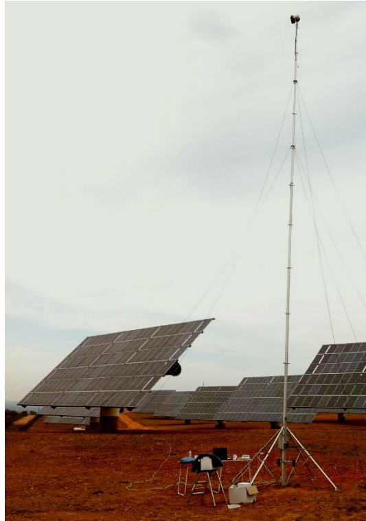
Fig. 3. Mástil telescópico sobre el que se ha ubicado la cámara para la adquisición de las imágenes.
