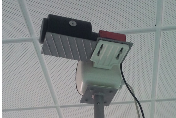
Fig. 4. Motor Pan-Tilt PTH300 con la cámara y óptica montada.
